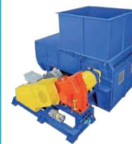
各種鉱工業分野で破碎機・粉砕機や各種選別機器を手がけてきたクボタは、その技術・ノウハウを監視にも活用。破碎、粉砕時の過負荷など機器の故障につながる状態を常に監視し、早期に異常検知することが可能です。
