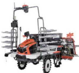
クボタグループは、田植え作業の負担軽減のため、1968年に初めてマット苗用の歩行形田植機を世に送り出しました。その後、農業従事者の減少や高齢化にともなう省力化へのニーズに対応するため、田植機の乗用化・大型化・同時作業化などを進めてきました。これからは、効率的な栽培方法の提案や、ICTの活用と自動運転による農作業の精密化を通じて、さらなる省力化と環境負荷低減に貢献していきます。
