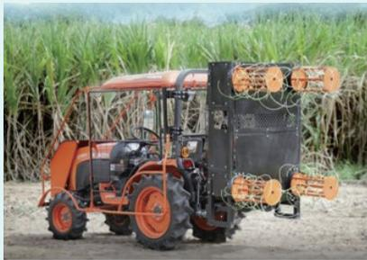
小型トラクタに装着したSLR110H
