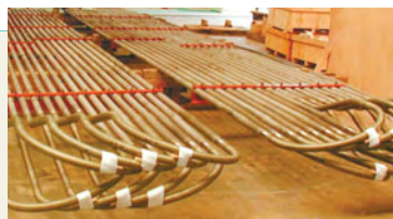
熱分解炉の主要設備クラッキングコイル
