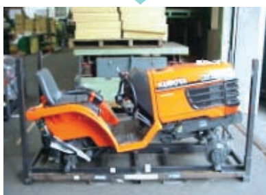
クレートからパレットへの変更およびリターンブル化により、廃棄していた梱包資材を削減
