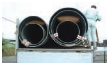
口径の小さいパイプ挿入による積載効率の向上
