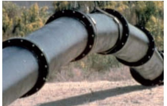
耐震継手ダクタイル鉄管路の屈曲状況
