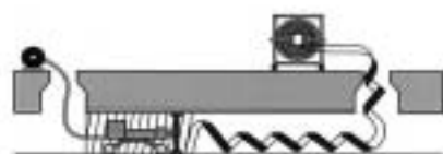
ダンビー工法施工イメージ
