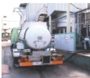
タンクローリー車を所定の位置に誘導し停車させる。 タンクローリー車のホースを注入口に取り付ける。
