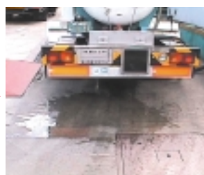
薬品(硫酸バンド)受け入れ時タンクローリー給液フランジ接続部より100L程度漏れた。
