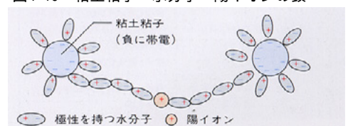
図4・10 - 粘土粒子・水分子・陽イオンの鎖
