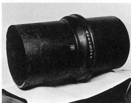
写真-2 宮内庁御所水道の24"鑄鉄管60年以上も使用されても外面腐食は殆んど認められず。
