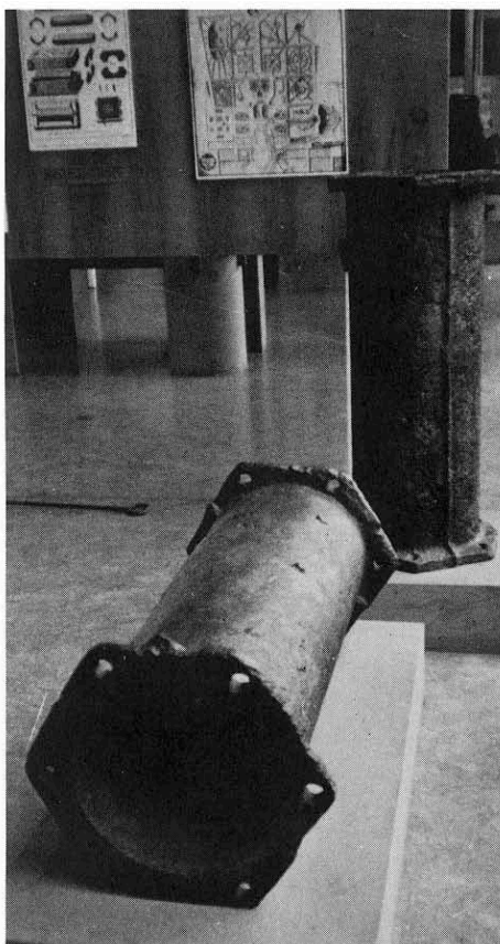
写真-1 ベルサイユ宮殿の噴水への導水鑄鉄管300年使用後も、なほ健全
