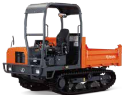
RY601D-3 最大積載量：600kg
