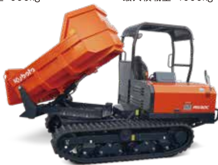
RG-15Y-5 （一方ダンプ仕様） 最大積載量：990kg
