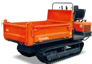
RG-15Y-5 （一方ダンプ仕様） 最大積載量：990kg
