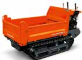
RY601D-3 最大積載量：600kg
