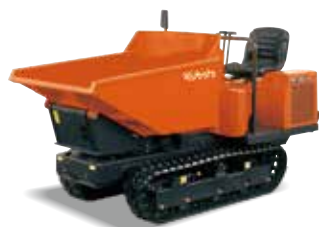
RG-15C-D4 （回転ダンプ仕様） 最大積載量：1000kg
