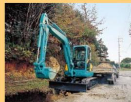
従来のシステム 負荷によって作業機に流れる流量が変化
