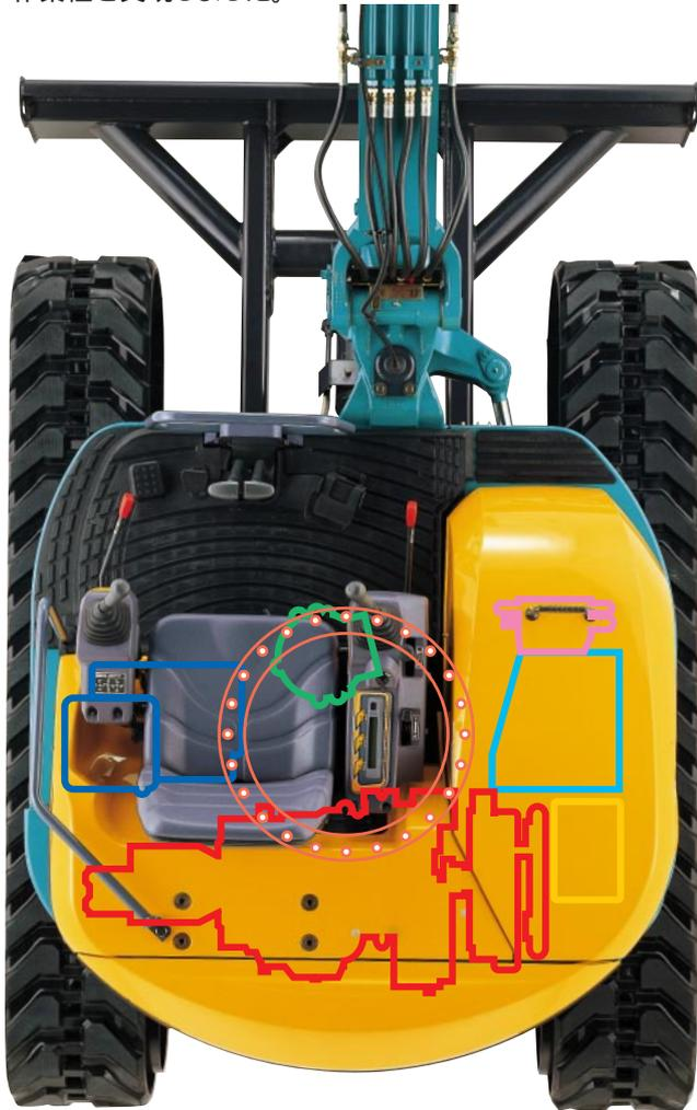
エンジン 燃料タンク バッテリー 旋回ベアリング
