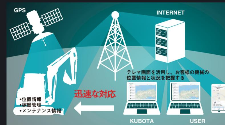
※エンジンの停止状態が一定期間続いた場合、省電力モードに移行します。このモードでは、位置情報などデータの取得が全て停止します。
