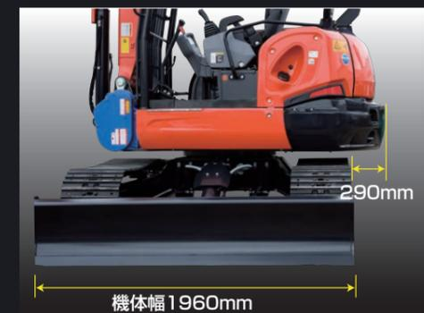
KX-57-6Eはより安定性を高めるために、機体後部を290mm伸ばしました。しかも、1,960mmと2mを切る車幅と相まって、狭い林道への進入や樹木の間での作業も安心して行えます。標準機ならではの安定性は、傾斜地での作業が多い林業に最適なミニバックホーです。
