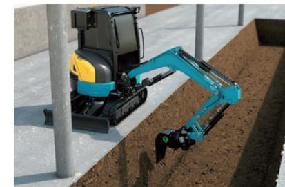
障害物があっても、機械の移動を最小限にして掘削・埋め戻し・整地作業を可能にします。
