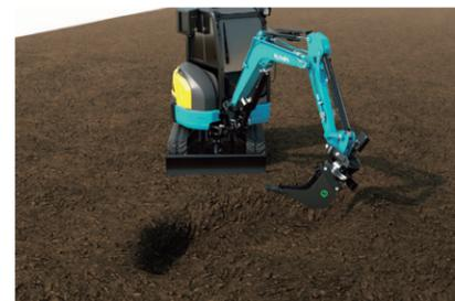
前後の掘削だけでなく、左右斜め方向への掘削作業もできます。
