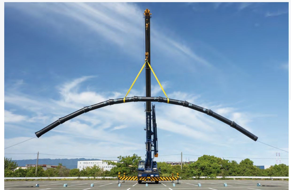
耐震型ダクタイル鉄管 (GX形) 呼び径500 吊上げ試験
