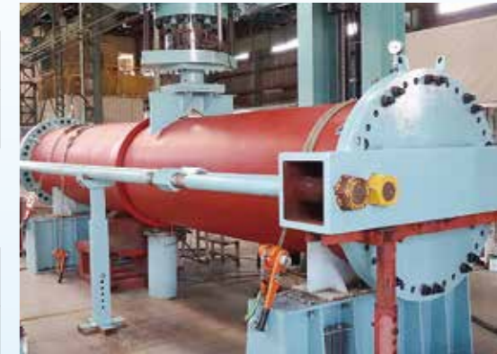
偏心荷重水圧試験状況(呼び径900)
