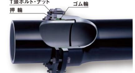
メカニカルタイプの継手で、施工性・可とう性・伸縮性に優れています。また、角ゴムと丸ゴムを一体化したゴム輪を使用しているため、丸ゴムのセルフシール効果で優れた水密性を発揮します。
