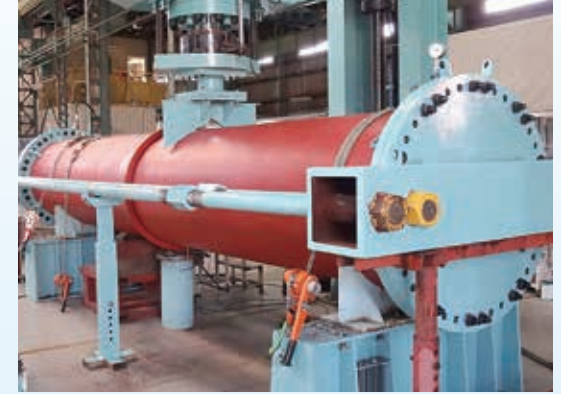
偏心載荷水圧試験状況(呼び径900) ※現行製品の外面は黒色に変更しています
