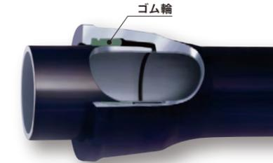
受口内面にゴム輪をセットし、挿し口を挿入するだけで接合できる、プッシュオンタイプの継手です。継手部は可とう性・水密性に優れており、多少の地盤変動や外荷重による振動・伸縮なども吸収します。
