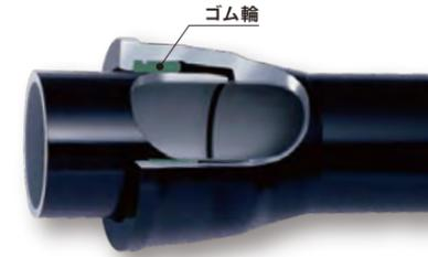
T形と同様のプッシュオンタイプを採用した1.0MPa以下で使用する継手であり、継手部は可とう性、水密性に優れています。内面にはシリカエポキシ樹脂塗装を採用し、従来のセメントモルタルライニングに比べ優れた水利特性を有しています。
