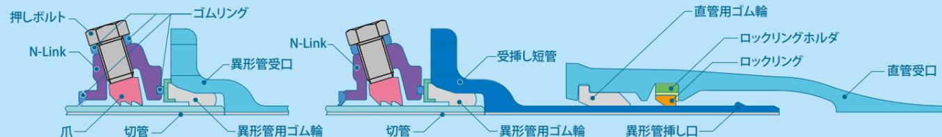
ゴムリングを備え地下水の浸入を防止し、爪による傷部の防食対策を施しています。
