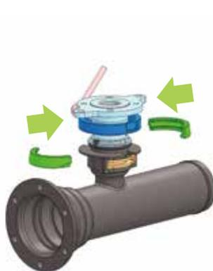
③ 押えリングを回転させ、割りリングを固定する。
