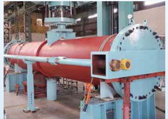
偏心载荷水圧試験状況(呼び径900)
