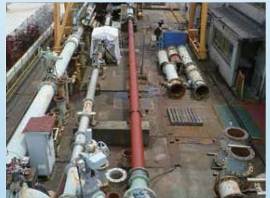
流速係数Cの試験管路
