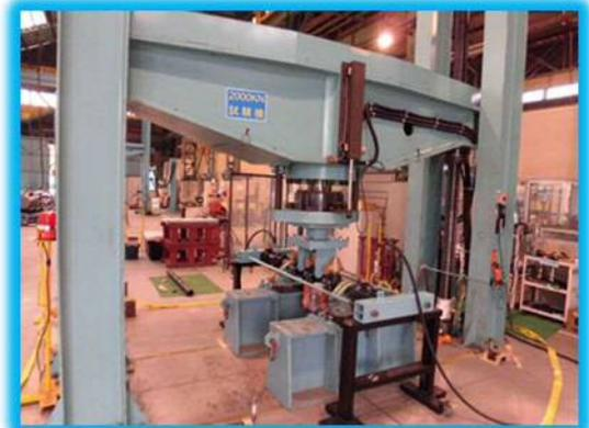
写真 曲げ強度試験の様子
