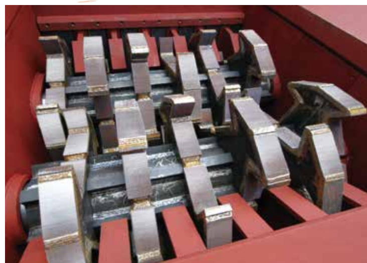
能力重視の V(volume) タイプ 処理能力を重視したタイプの刃物で大型のバラものを 効率よく破碎できます。
