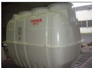
FRP製浄化槽
