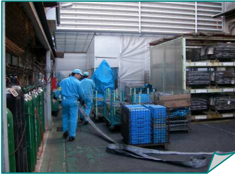
【屋内消火栓による消火】
