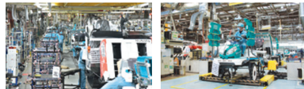
田植機、コンバイン、汎用トラクタのミックス生産ライン 田植機の完成品検査ライン
