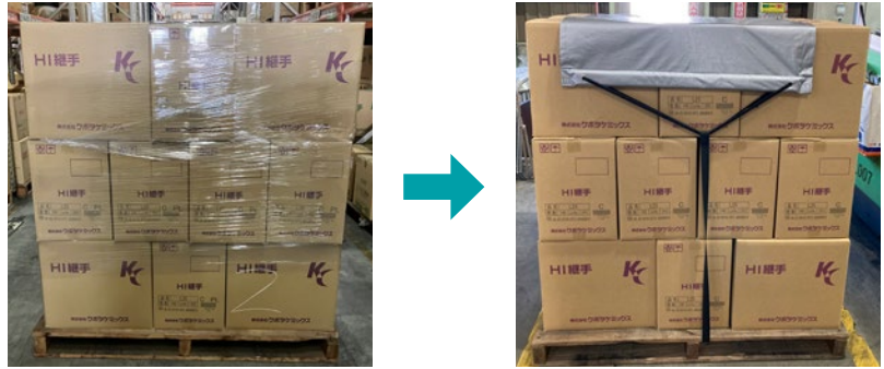
製品保管時のプラスチックフィルムを用いた固定を見直して廃棄物を削減しました。
