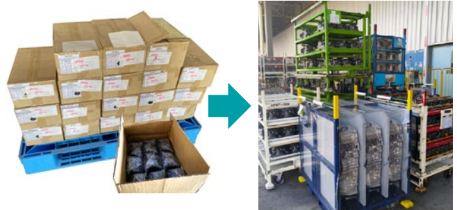
Kubota Precision Machinery (Thailand) Co., Ltd. (タイ)では、使い捨て段ボールとプラスチックフィルム梱包を見直し、廃棄物を削減するとともに、作業の省力化を図りました。
