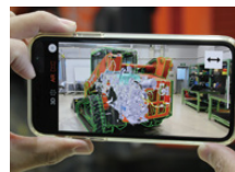
建設機械の故障診断 アプリを開発
