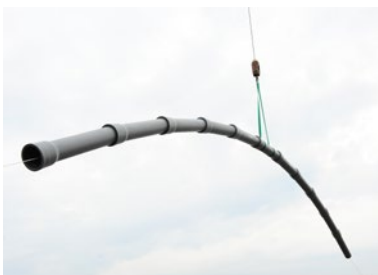
災害時にも水供給を可能とするダクトイル鉄管
