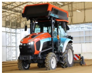
水素燃料電池（FC）トラクタ 試作研究機
