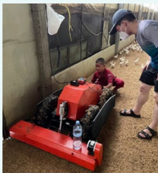
養鶏場の敷き藁を管理する電動機の開発 (タイ)
