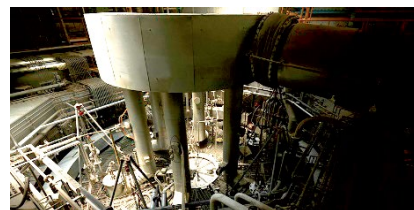
残さや灰を液状化・スラグ化し、資源としての再利用を可能とする回転式表面熔融炉
