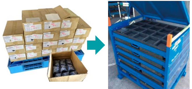
Kubota Precision Machinery (Thailand) Co., Ltd. (タイ)では、使い捨て段ボールとプラスチックフィルム梱包を見直し、廃棄物を削減するとともに、作業の省力化を図りました。
