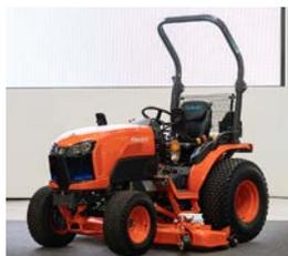
農機使用時のCO<sub>2</sub>排出抑制に貢献する電動トラクタ
