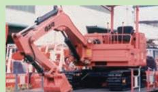
後のクボタミニバックホーのベースとなった全旋回式小型油圧ショベル
