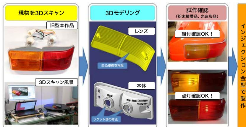
旧型部品の多くは3Dデータがないため、現物を3Dスキャンし、モデリングすることで3Dデータを作成し、再製作可能にします。
