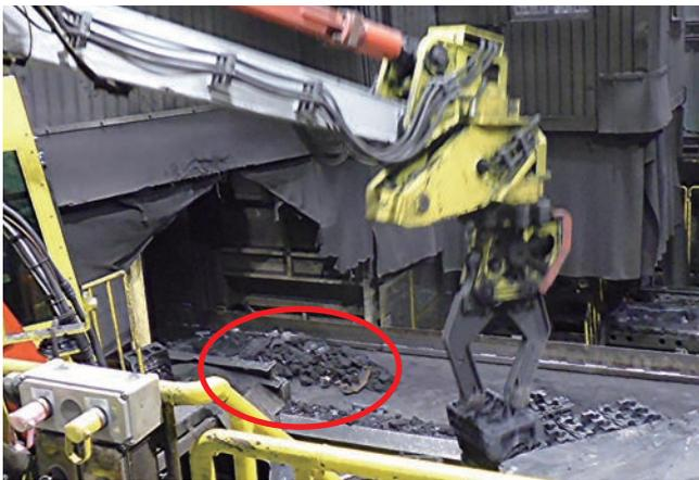
クボタ恩加島事業センターでは、製品の製造工程で発生した鋳物廃砂(赤枠部)を再生する回収設備の利用率を向上させることで、廃棄物の削減に取り組んでいます。2020年度はこの取り組みにより、約1,550tの廃棄物排出量を削減しています。
