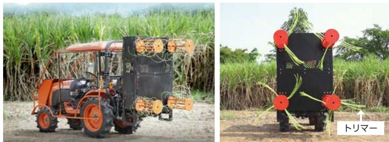
小型トラクタに装着したSLR110H
