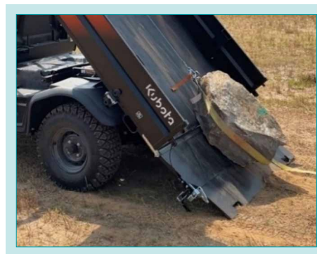
Fig. 12 Cargo Extended Gate 図 12 荷台拡張ゲート
