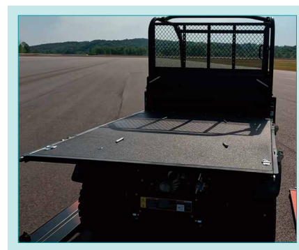
Fig. 8 Flat Bed Configuration 図8 フラットベッド状態
