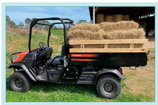
Fig. 7 Cargo Raised Stake Sides 図7 荷台積載高アップ用の側板
