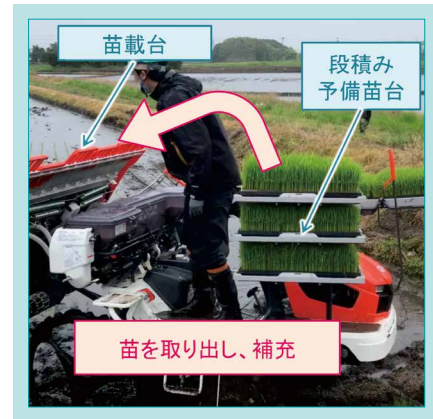
図3 段積み式予備苗台の苗の補給作業
