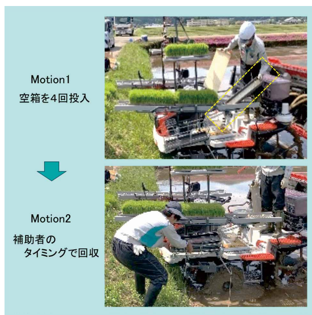
図 12 新機構での空箱回収の動作 Fig. 12 Operational Actions Using the New Mechanism
