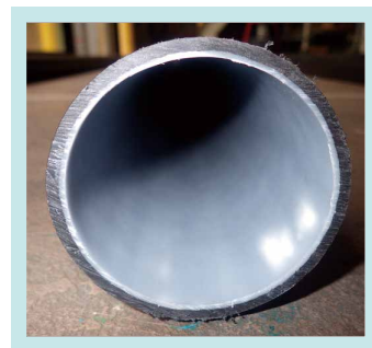
図6 耐衝撃性を改善したパイプの内面 Fig. 6 Improved Shock-Resistant Inner Surface of the Pipe
