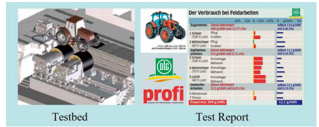
図 3 欧州燃費試験 (DLG 燃費試験) 1) 2)
