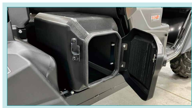
Fig. 14 Under-bed Storage Box 図 14 荷台下収納ボックス
