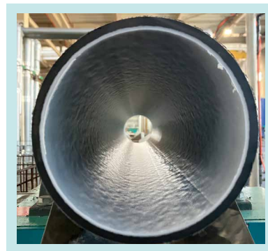
図8 凹凸改善後パイプ内面
