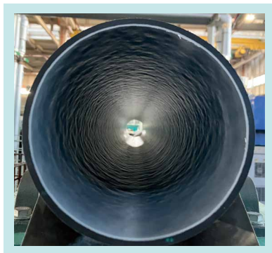
図7 凹凸改善前パイプ内面
