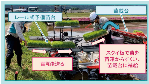
図2 レール式予備苗台の苗の補給作業
