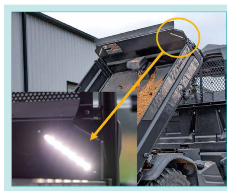
Fig. 13 Cargo Panel Lamp 図 13 荷台用パネルランプ
