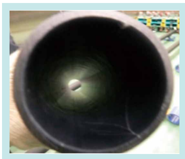
図5 割れたパイプの内面 Fig. 5 Inner Surface of a Cracked Pipe
