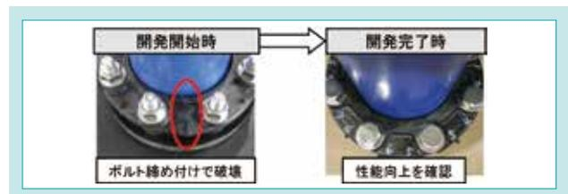
図 4 耐破壊性の実験結果
