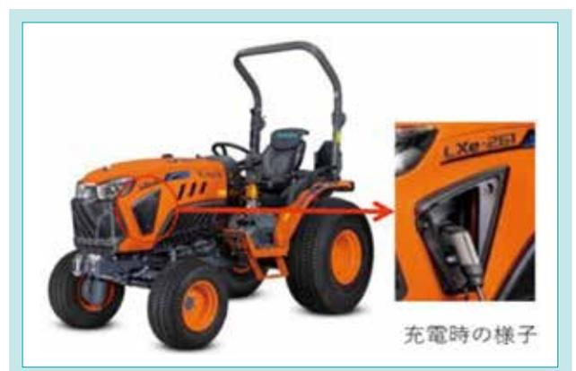
図 13 ボンネット内への急速充電口の格納
