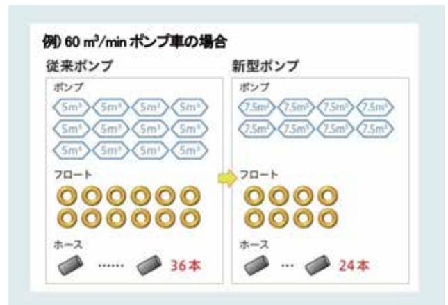
図2 排水ポンプ車の搭載品の数量比較
