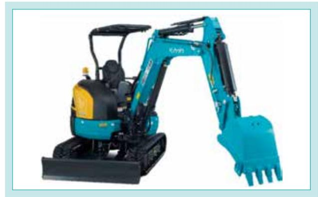
図2 3tクラス後方小旋回機 U-30-6 α
