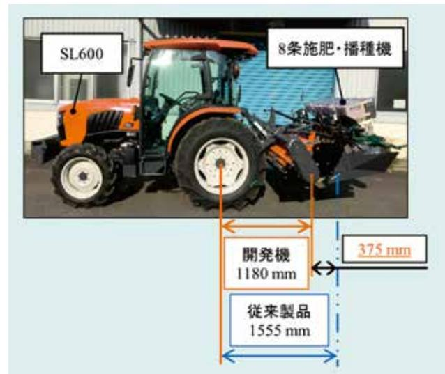
図6 トラクタ後輪車軸からロータリ爪軸までの距離
