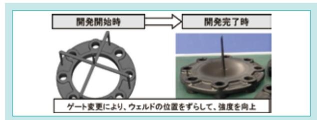
図 2 金型ゲートの変更
