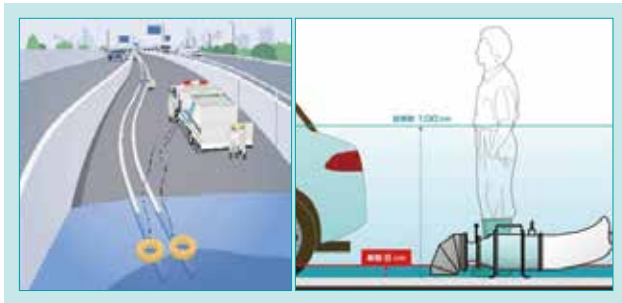
図5 低水位排水ポンプ Fig. 5 Low Water Level Pump
