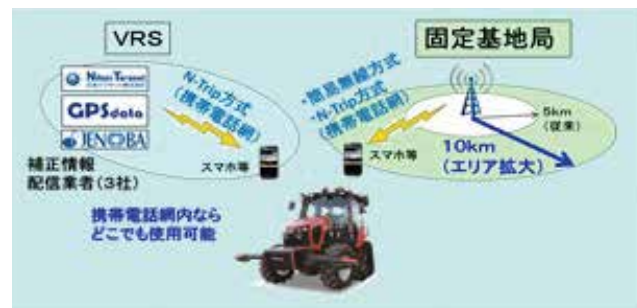
図 12 広域基地局システム Fig. 12 Wide Area Base Station System
