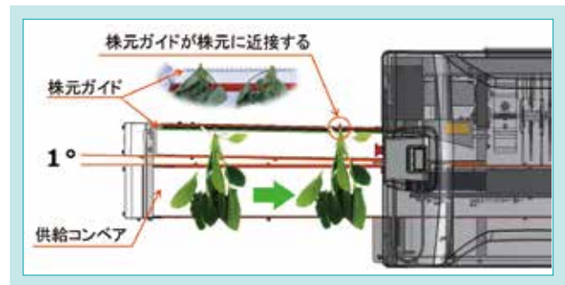
図7 開発機における供給部のコンベア配置 Fig. 7 Conveyor Arrangement of the Feeding Unit of "NC301"
