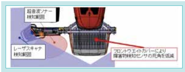
図 10 フロントウエイトカバー付近の検知エリア Fig. 10 Detection Area Near the Front Weight Cover
