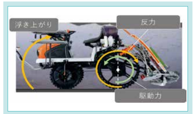
図 9 負荷による機体の浮き上がり Fig. 9 Lifting of the Body due to Load
