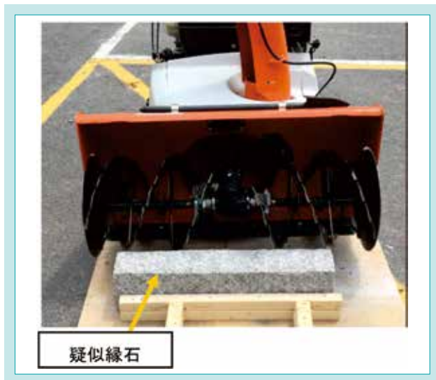
図 11 トルクリミッタの作動試験 Fig. 11 Torque Limiter Operation Test
