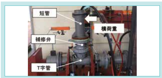
図8 横荷重負荷試験の状況 Fig. 8 Aspect of Lateral Load Test
