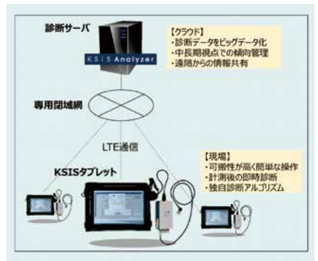
図 9 KSYS 診断共通プラットフォームのシステム構成 Fig. 9 KSYS Platform System Diagram
