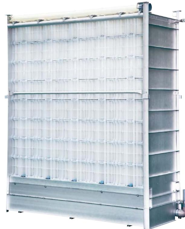
納入されるクボタの液中膜。微生物を利用して排水を浄化し、浄化された処理水と浄化に用いた微生物とを分離する。
