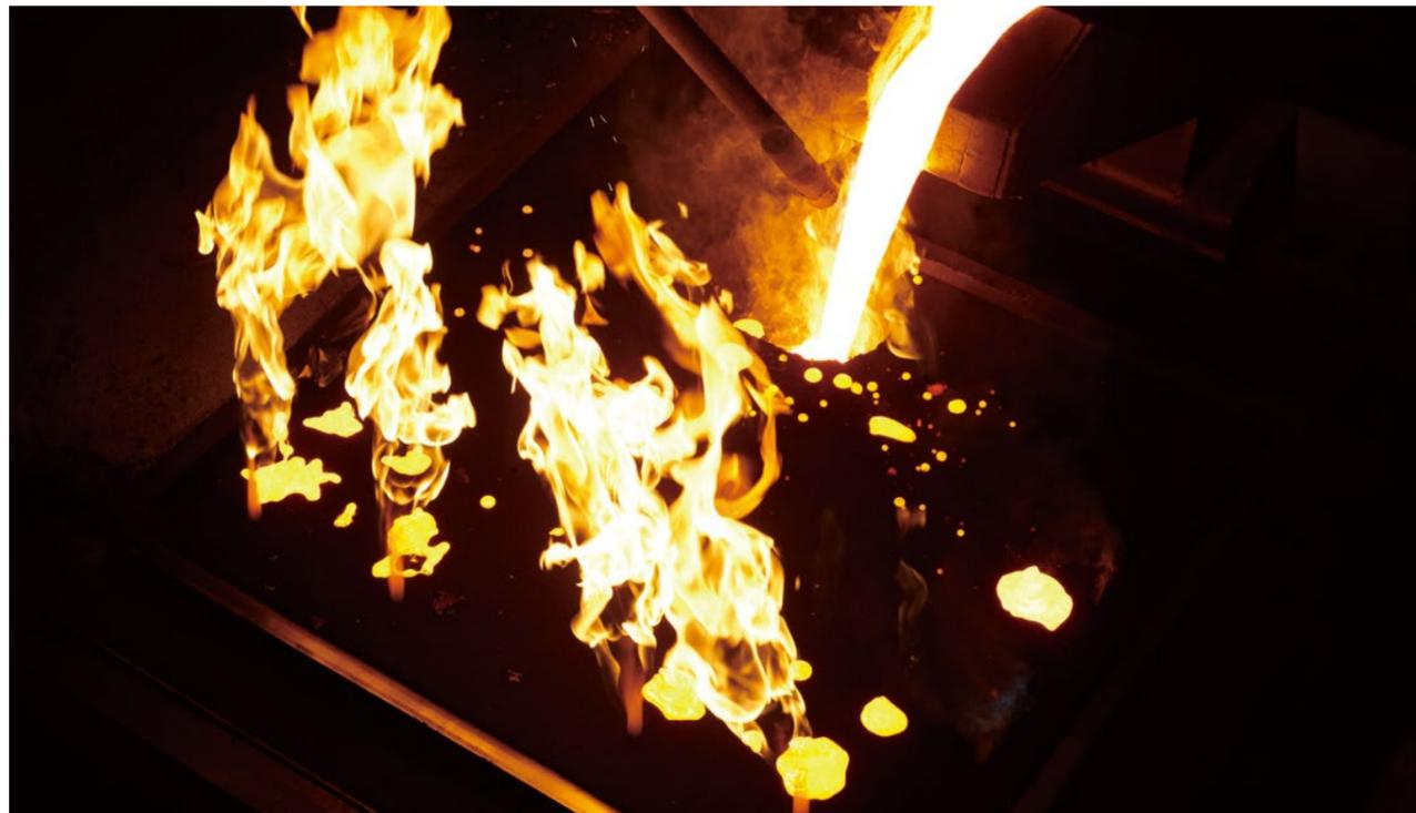
SKMTでの鋳物の製造風景。真っ赤に焼けた鉄を流し込み形を作る
