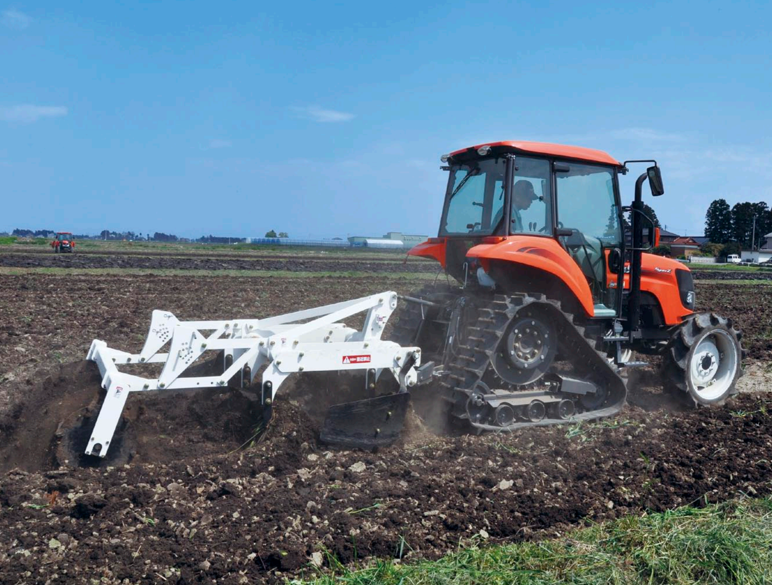
実証試験風景。心土破碎による浸透除塩を基本にして、耕起していく
