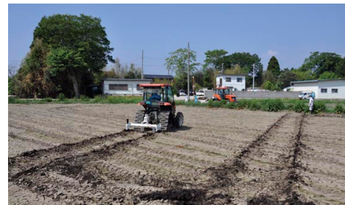
サブソイラで溝を入れ水の縦浸透を高めた後、 様々な機械を使用し方法を変えて実証試験は行われた 写真左上) サブソイラで溝切り 写真右上) ブラウで表土を反転・耕起 写真右下) 耕起・畦立て
