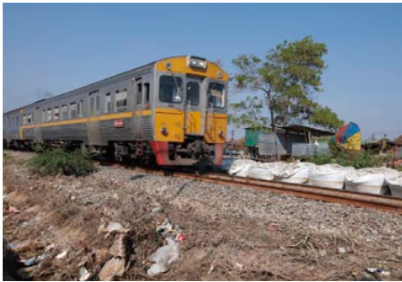
洪水から鉄道を守るために置かれたビッグバッグ (ドンムアン空港北)
