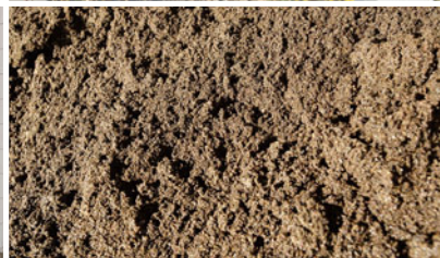
脱水汚泥の一部は清掃工場の焼融溶融炉で ごみと混焼し、砂状のスラグ(下)にして、 アスファルトなどの材料に利用される —— 浜松市西部清掃工場にて
