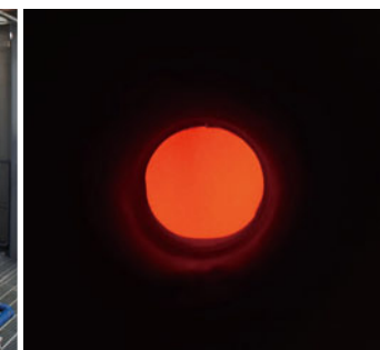
のぞき窓から見た炉の内部。循環流動炉では、従来炉の通常焼却（800℃）から高温焼却（850℃）に転換することにより、N 2 O排出量を約6割減少させることが可能となる
