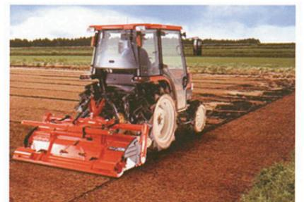
センサーにより作業速度を落とすことなく均平な作業を可能にした「モンローマチック」
