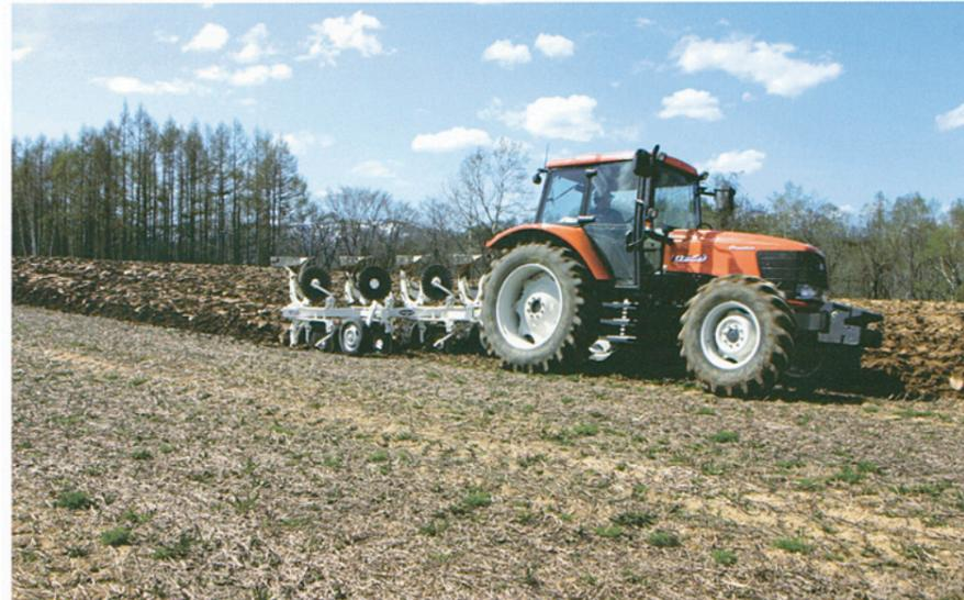
ブラウ(土を帯状に切断反転させ、深く耕す)作業
