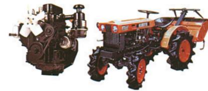
1971年に開発した超小型4輪駆動トラクタ・ブルトラB6000(右)と、搭載エンジンの立形2気筒ディーゼルエンジン(左)
