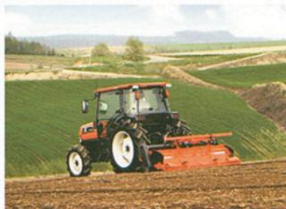
Newスーパーテクノモノロー:モノローマチックの改良型。水平制御機能、旋回機能を更に向上させた
