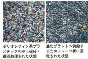
ポリオレフィン系プラスチックのみに破碎・選別処理された状態
