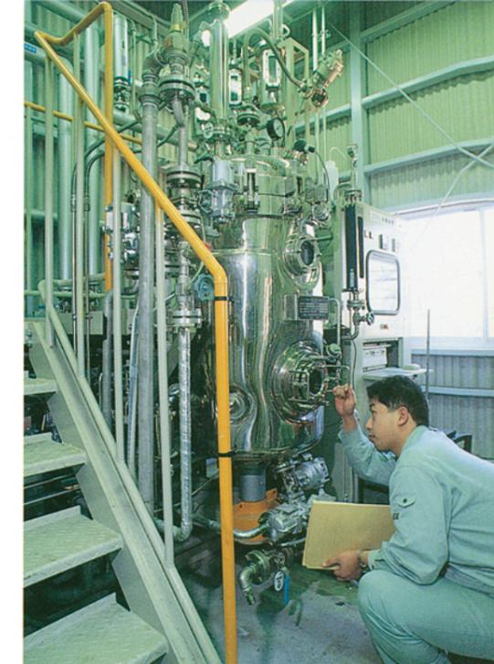
BT菌培養のための200ℓタンク(上)と制御モニター(上左)
