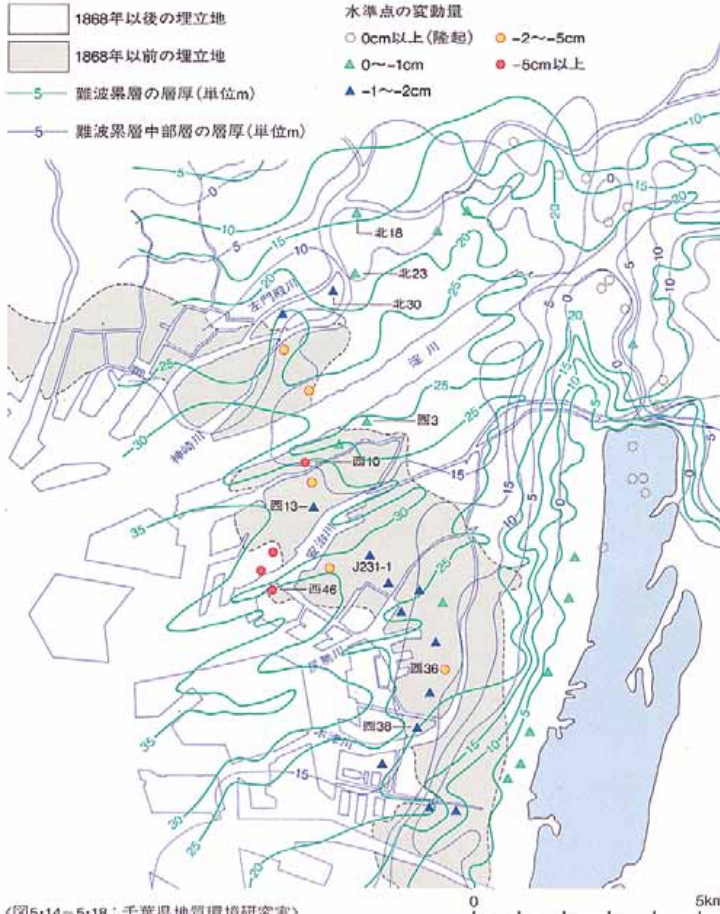
図5・17－西大阪平野の水準点変動と難波累層および難波累層中部層(海成粘土層)の層厚分布
