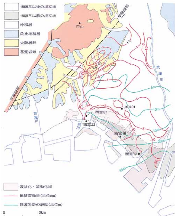
図5・12—西宮市の地盤沈下と難波累層の層厚および液状化・流動化分布
