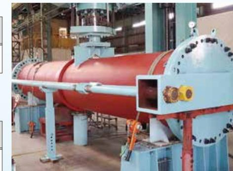
偏心載荷水圧試験状況 (呼び径900)
