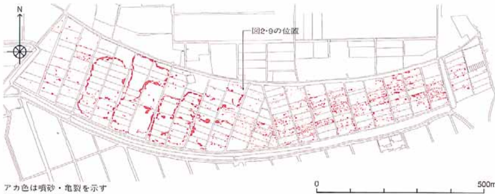
図2・7—馬蹄形状の長い亀裂・噴砂の分布(香取郡神崎町)
