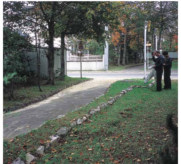
写真3・5-火山灰質細粒砂の噴砂
