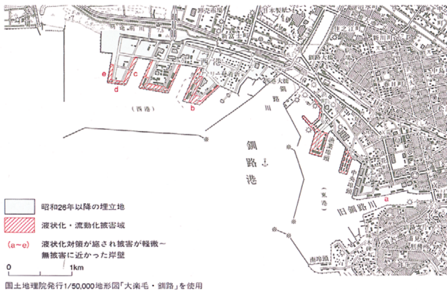
図7・13-釧路沖地震による釧路港の液状化・流動化被害
