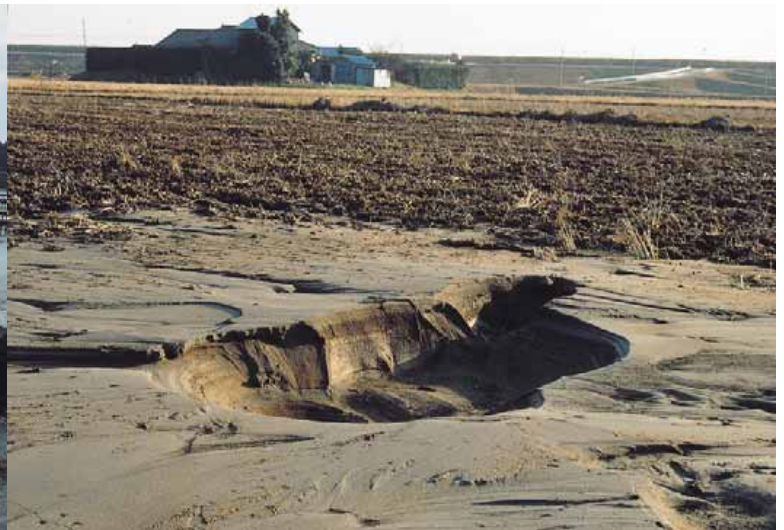
写真2-2ー長径2mの噴砂孔(佐原市石納)
