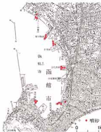
図7-18-函館港の液状化・流動化被害
