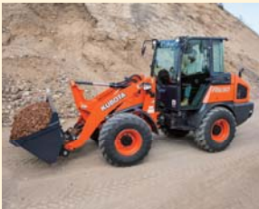
ホイールローダ 主に建設現場や農場などで、運搬・積込作業を行います。
