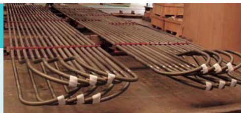
鋳鋼 石油化学プラントでエチレン精製などに使用されます。
