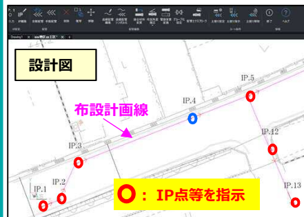
布設計画線上に、IP点や通過点を入力、異形管・弁類等を指示
