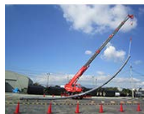
耐震型ダクティル鉄管 GX形 呼び径 400
