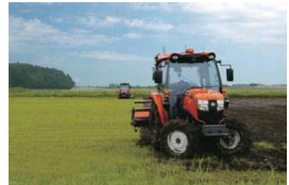
アグリロボトラクタによる有人機・無人機の2台による協調運転作業試験
