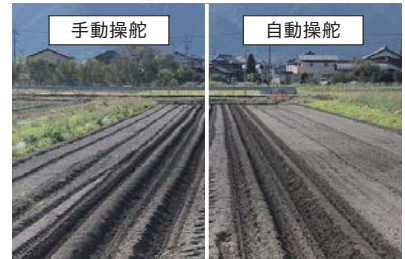
GS機能搭載のクボタトラクタ グラノバ(NB21GS)による直進作業試験。 左側がトラクタ操縦初心者による手動操舵、右側が自動操舵。熟練者でも直進精度を保つことは、負担の大きな作業となる。
