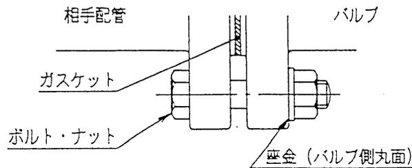
d. ボルト・ナットの締付け順序と締付けトルク
