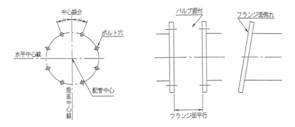
d. 継手材 (フランジボルト・ナット・ガスケット) がそろっている。 (外面粉体塗装の場合、塗装の損傷を防止するためにバルブ側には、座 金が必要です。)
