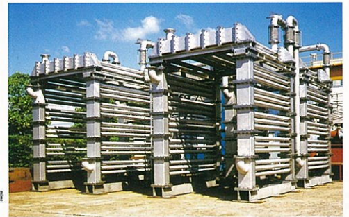
4300PS 実機大容量 吐出水路クーラ
