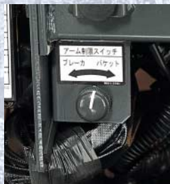
通常バケット、ブレーカ装着の2モード設定ができます。
